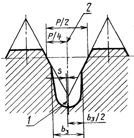
1 — реальное положение оси канавки;
